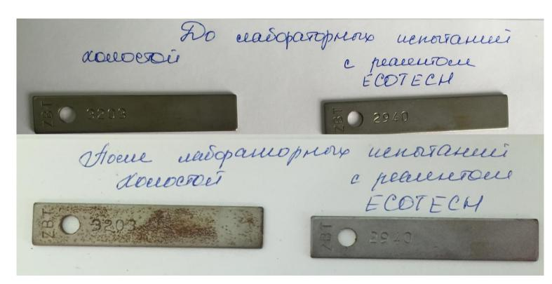
**Вывод:** Реагент ECOTECH ING 2210 с дозировкой 10 мг/л снижает скорость коррозии циркуляционной воды в 8,7 раза.
